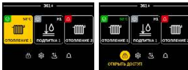
Рис.6. Главный экран ECL4 Control 361 Plus с активной навигацией в области модулей автоматики (слева) и в области общих меню (справа).
